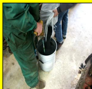
Ajout de grains de caoutchouc noir au mélange résine/durcisseur .
